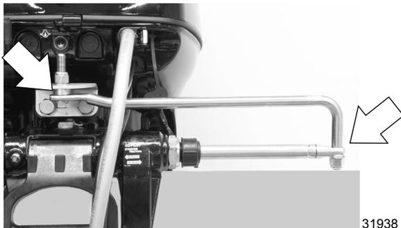
3. Нанесите антикоррозийную смазку Quicksilver или Mercury Precision или смазку с тефлоном 2-4-С на следующие места.
